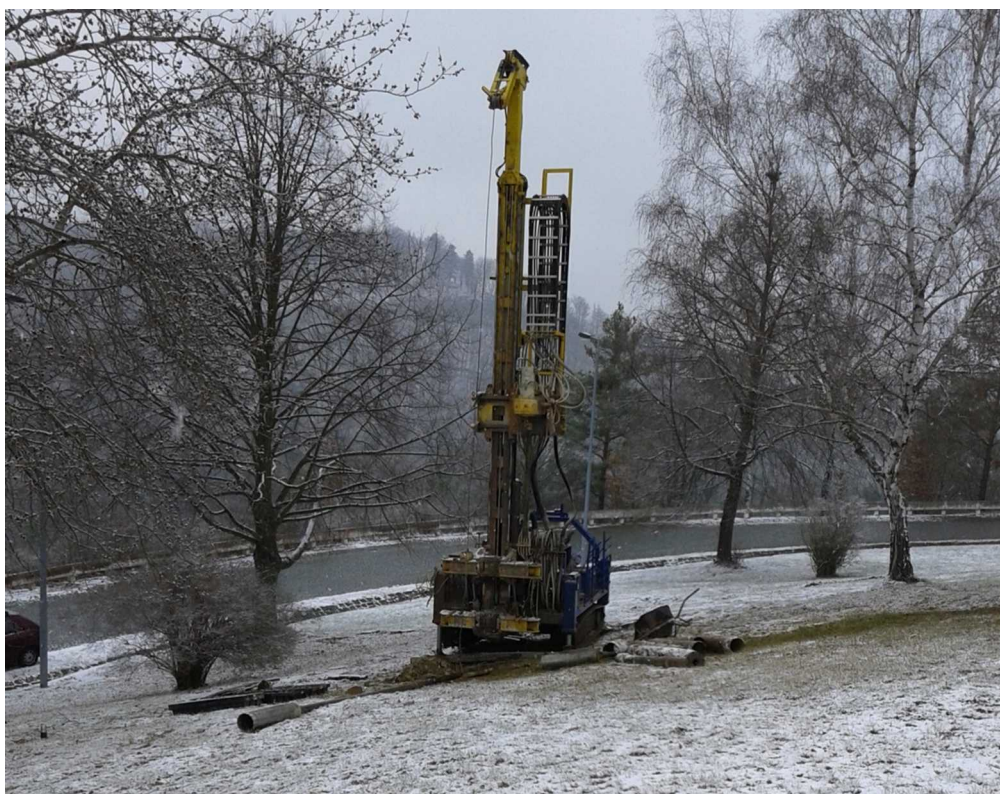
Obr. č. 3.1-2 Vrtná souprava RDBS II (vrt V3)
