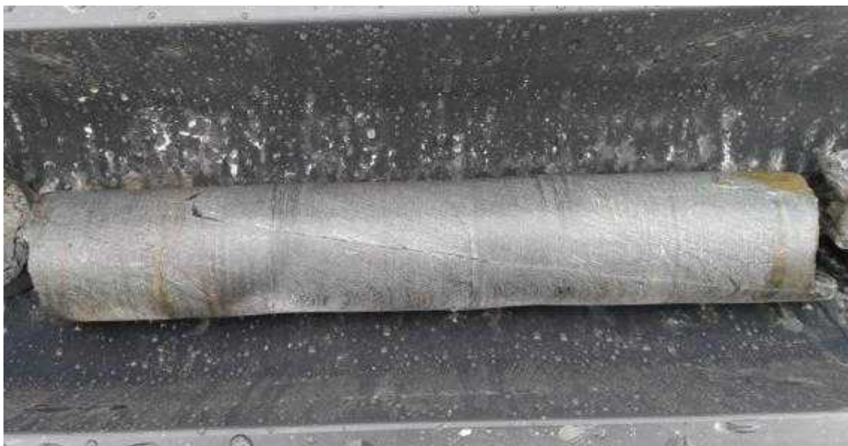
Obr. č. 4.1-1 Podélné tektonické poruchy v horninovém masivu
