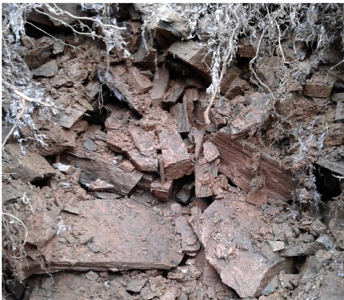
Obr. č. 4.1-3 Kopaná sonda č. 3 - kamenitá suť bez meziprostorové výplně
