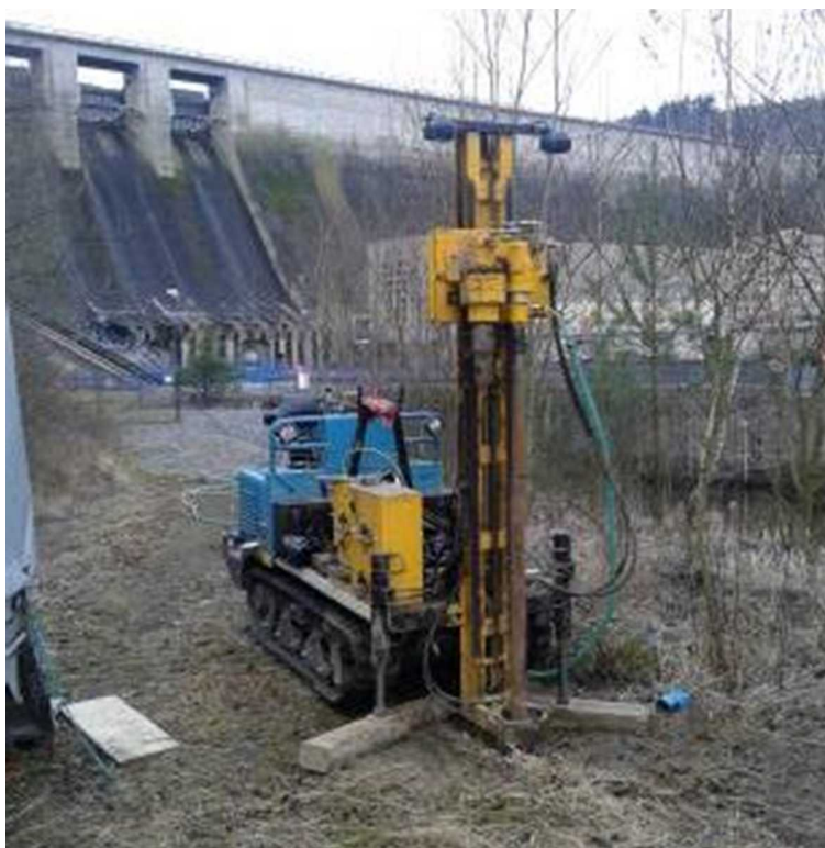
Obr. č. 3.1-1 Vrtná souprava RDBS – Mini (vrt V7)
